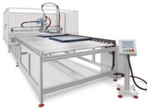
Ejemplo de robot para la aplicación de cola en paneles planos con o sin borde
